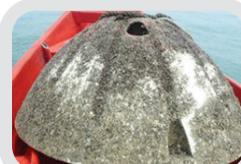
Intensiti mendapan "biofouling" pada pemukaan bingkai ADCP bersalut "anti-fouling epoxy" berdasarkan CA/PEG-PDMS dan Mxene/MoS<sub>2</sub> selepas dipasang selama 2 minggu di dasar laut, persisiran Bagan Lalang, Sepang.
